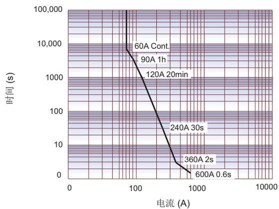
备注: 以上数据在环境温度为85℃, 导线截面积≥15mm<sup>2</sup>条件下测得。数据仅作参考, 请勿直接用于选择熔断器。
