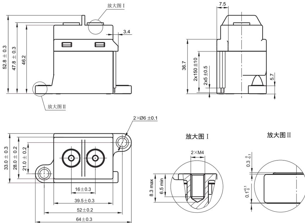
备注: 产品部分外形尺寸未注尺寸公差, 当外形尺寸  $\leq 10\text{mm}$ , 公差为  $\pm 0.2\text{mm}$ ; 当外形尺寸在  $(10 \sim 50)\text{mm}$  之间时, 公差为  $\pm 0.3\text{mm}$ ; 当外形尺寸  $> 50\text{mm}$ , 公差为  $\pm 0.4\text{mm}$ 。
