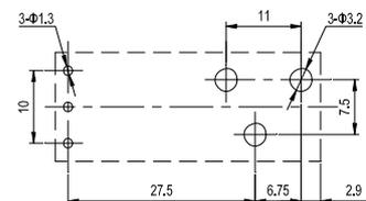
备注: (1)产品外形尺寸未注尺寸公差, 当外形尺寸 $\leq 1\text{mm}$ 时, 公差为 $\pm 0.2\text{mm}$ ; 当外形尺寸 $1\text{mm} \sim 5\text{mm}$ 时, 公差为 $\pm 0.3\text{mm}$ ; 当外形尺寸 $\geq 5\text{mm}$ 时, 公差为 $\pm 0.5\text{mm}$ 。
