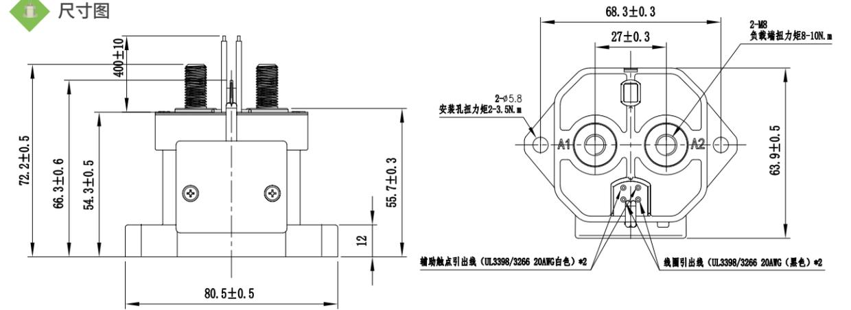
备注: 1. 紧固件规格: 2xM8螺母; 2. 接触器底座螺丝为M5 扭力要求2-3.5N·m; 3. 主触点连接螺丝为M8螺丝扭力为8-10N·m; 4. 主触点连接铜牌横截面积≥120mm<sup>2</sup>
