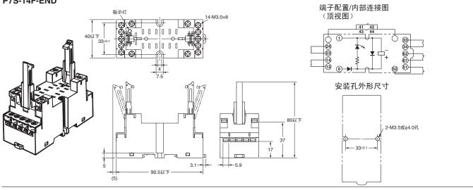
背面安装插座 (印刷基板用端子)
