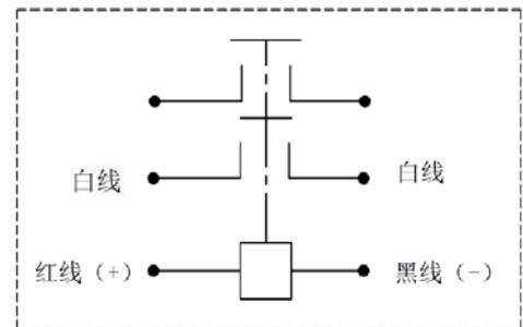
备注: 负载无极性, 辅助触点无极性, 线圈有极性
