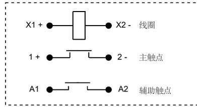
备注: 负载和线圈均有极性; 辅助触点无极性。
