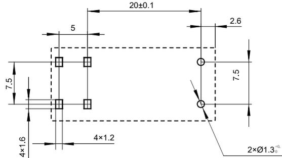
备注: (1) 产品部分外形尺寸未注尺寸公差, 当外形尺寸 $\leq 1\text{mm}$ , 公差为 $\pm 0.2\text{mm}$ ; 当外形尺寸在 $(1\sim 5)\text{mm}$ 之间时, 公差为 $\pm 0.3\text{mm}$ ; 当外形尺寸 $> 5\text{mm}$ , 公差为 $\pm 0.4\text{mm}$ ;
