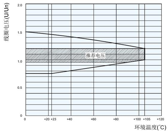
备注: 继电器使用过程中, 如果激励电压超过额定电压将会导致继电器电耐久性降低。在推荐电压范围内, 对电耐久性的影响会小一些。超过图中曲线规定的上限值, 继电器线圈的绝缘有可能会被损坏。
