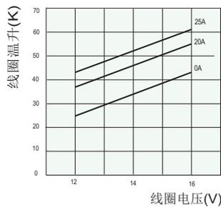
备注: 测试的PCB板尺寸为双层板, 铜箔厚度4oz(140 $\mu$ m), 铜箔宽度10.64 $\times$ ( $\pm$ 5%)mm, 长度为(50 $\pm$ 1)mm, 外接导线为5.0mm<sup>2</sup>. PCB板T<sub>g</sub>为150°C。
